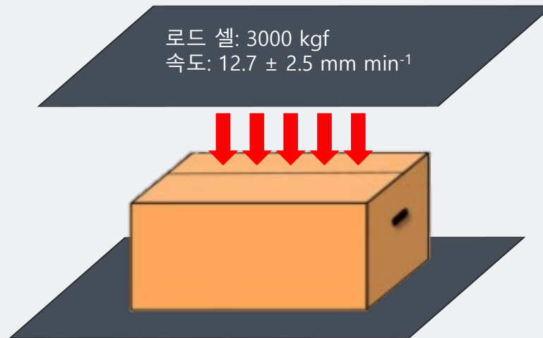
그림 5. 골판지 상자 압축 강도 시험 도식화
